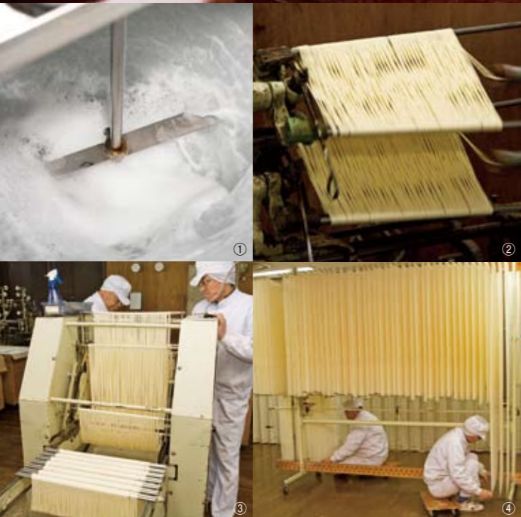
11～3月の寒冷期、早朝から始められるそうめん作り。各工程で熟成を重ねながら生地がゆっくりとのばされていく。①塩と水を配合する「なかだて」。塩の量はその日と翌日の温度・湿度によって決まる②細くした麺を二本の管に八の字にかけていく「かけば」を行い、数時間熟成させる③「こびき」で約50cmまでのばし、翌日までじっくり熟成させる④機にかけ、そうめんの細さまで引きのばして干す「かどばし」。以前は天日干しだったが近年ではほとんど室内で乾かされる
