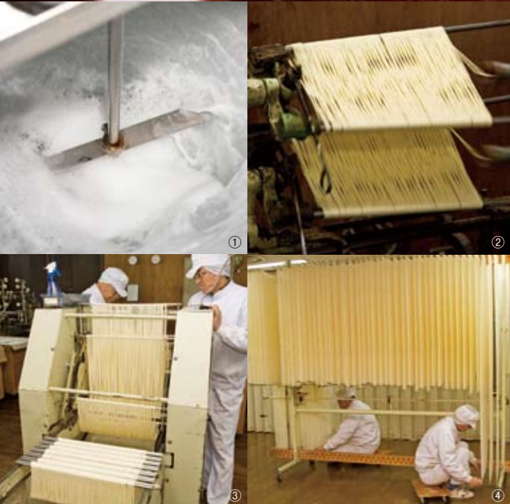
11～3月の寒冷期、早朝から始められるそうめん作り。各工程で熟成を重ねながら生地がゆっくりとのばされていく。①塩と水を配合する「なかだて」。塩の量はその日と翌日の温度・湿度によって決まる②細くした麺を二本の管に八の字にかけていく「かけば」を行い、数時間熟成させる③「こびき」で約50cmまでのばし、翌日までじっくり熟成させる④機にかけ、そうめんの細さまで引きのばして干す「かどぼし」。以前は天日干しだったが近年ではほとんど室内で乾かされる
