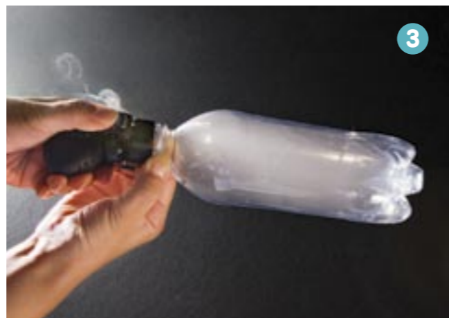
3 フイズキーパーのロックをはずして一気に空気を抜くとペットボトルの中が白く曇る
