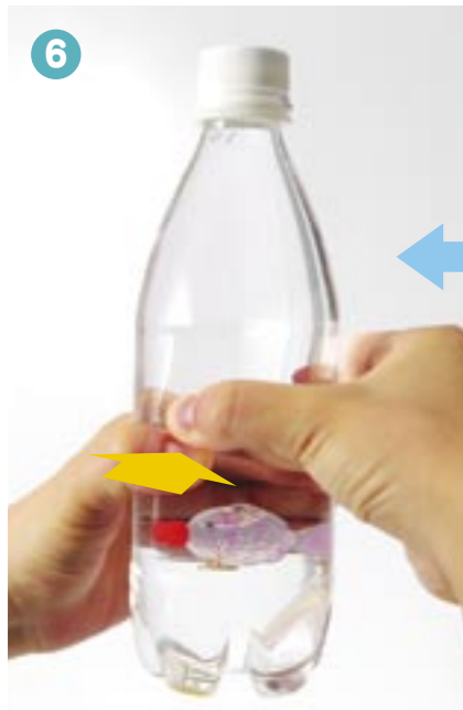
7 両手で強くペットボトルを押すと、浮かんでいたしょうゆ入れがゆっくと沈み始めます
