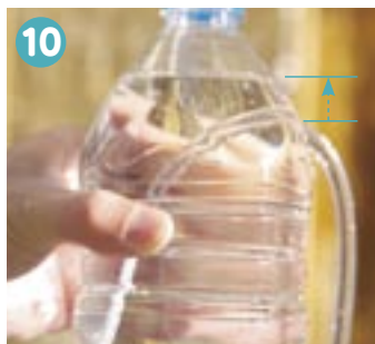
10 チューブの曲がったところより水の方が高くなるとチューブから水が噴き出す
