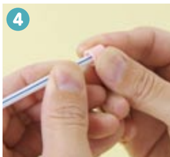
4 チューブにさしたストローの片方にたれびんのふたを着ける (両面テープなどで貼ると固定しやすい)
