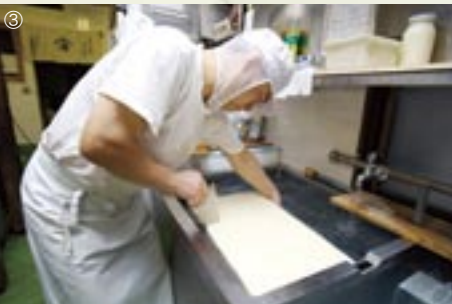
夜明け前から作業が始まる豆腐づくり。①すり潰され、高温の釜で蒸された大豆は豆乳とおからに分けられる②大豆100%の豆乳はにがりと混ぜ合わされ成型される③冷やされて固まった豆腐が切り分けられる④できあがった豆腐は地下水の「プール」で冷やされる【撮影協力=京都市下京区「久保田豆腐店」】
