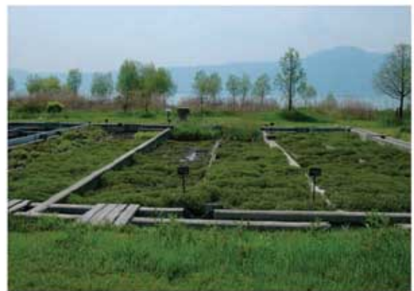
浅池型浄化実験施設
