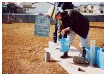
図 4-9 透水試験 (供用前)
