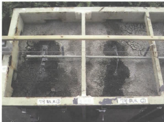
図 3-1-2 通水再開直後(左)および、再閉塞による湛水状況(右)
