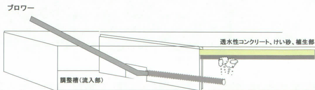
図 4-1 洗浄試験概要
