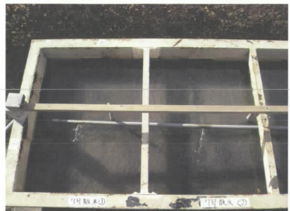
図 3-1-2 通水再開直後(左)および、再閉塞による湛水状況(右)
