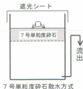
図 2-6-2 カラム実験装置および浸透ろ過装置の概念図
