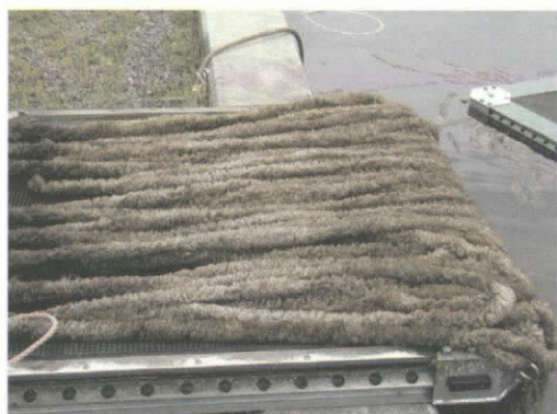
図 2-8 紐状接触材（左：ポリプロピレン+ポリエチレン製、右：ポリプロピレン製、いずれも径 45mm）
