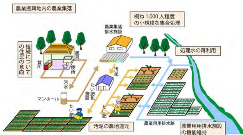
図 3.1.9 農業集落排水処理施設の仕組みのイメージ
