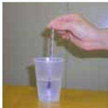
①採水した水の温度（水温）を測ります。
