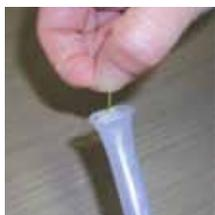
③パックテストのチューブ先端のラインを抜き取ります。
