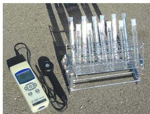
図 10 太陽光による不活化評価実験
