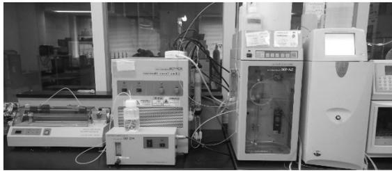
図1 燃焼イオンクロマトグラフィーの外観
