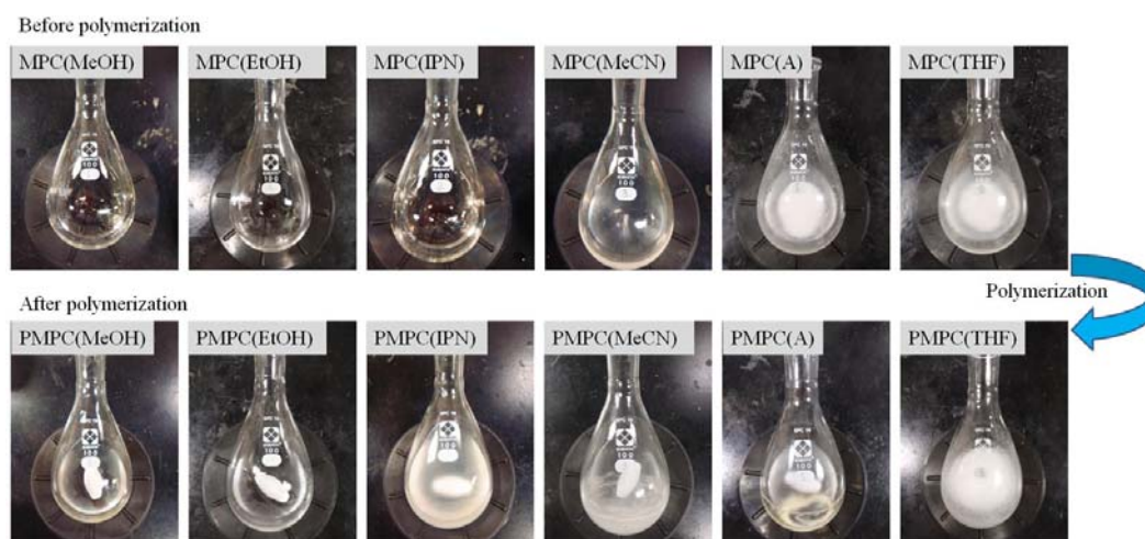
図 1 1. MPC モノマーおよび同ポリマーの溶媒に対する溶解状態
