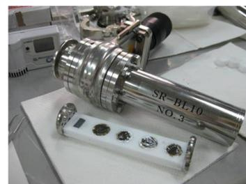
図 8 セルを取り付けたセルラックとトランスファーベッセル
